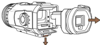
2. Instale la batería y la tarjeta Micro SD
