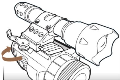
NOTA: El iluminador de infrarrojos se puede montar en cualquier lado de la cámara, según sus preferencias, invirtiendo la montura en el paso 3.
