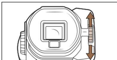
9. Okrećite selektorski prsten za promjenu između dnevnog, sumračnog i noćnog načina rada
