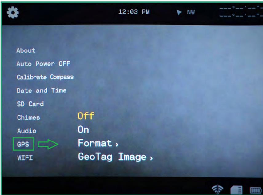
3. Basculez vers GeoTag Image et vers la droite sur l'option Off ou On. Appuyez sur SET pour sélectionner.
