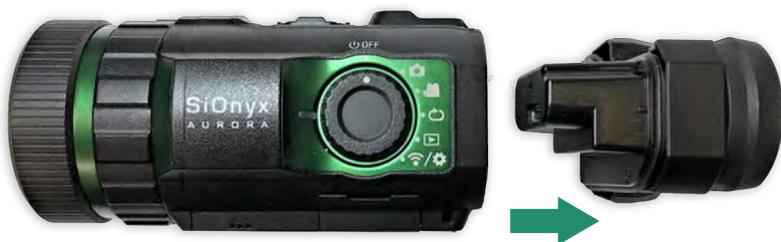
4. Faites glisser la batterie dans le logement pour batterie.
