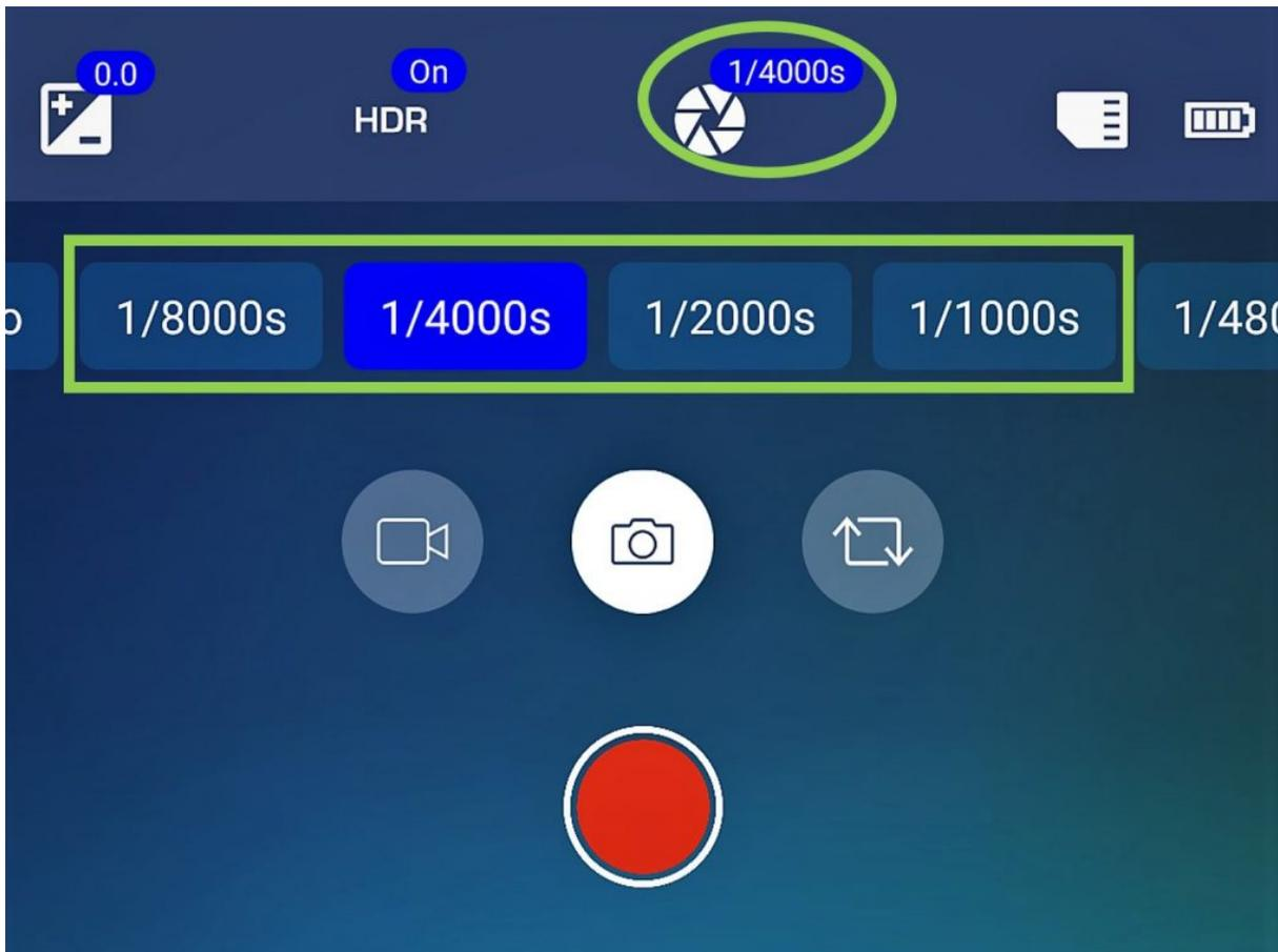
**HINWEIS:** VERSCHLUSSGESCHWINDIGKEIT BESCHREIBT, WIE SCHNELL DER VERSCHLUSS ÖFFNET UND SCHLIESST. EINE SCHNELLE GESCHWINDIGKEIT STOPPT DIE BEWEGUNG UND LÄSST WENIGER LICHT EIN, UND EINE LANGE GESCHWINDIGKEIT LÄSST MEHR LICHT EIN.
