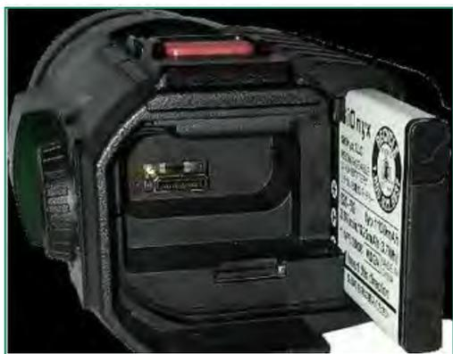
4. Deslize a bateria no slot da bateria.
