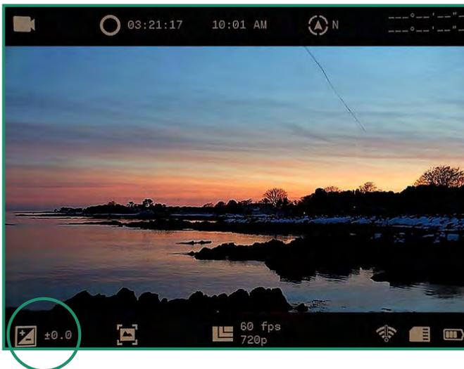
A configuração de compensação/ganho de exposição está localizada na parte inferior esquerda do menu do visor.
