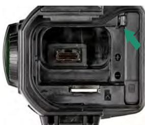
3. Pressione a aba no lado esquerdo da bateria e deslize a bateria para fora. Deslize o visor de volta em seu slot.
